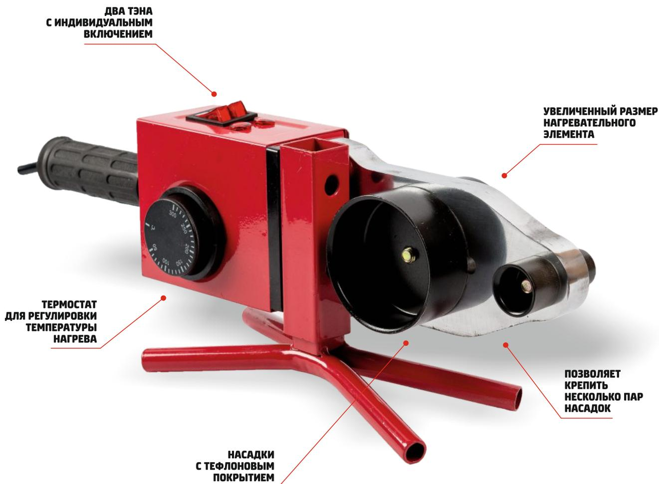
Предназначен для ручной сварки в раструб пластиковых труб и фитингов с наружным диаметром от 20 до 63 мм по принципу муфтовых соединений. Обеспечивает надёжное сваривание методом расплавления поверхности материала трубы - диффузное соединение материала. Предусмотрен термостат для регулировки температуры нагрева.
